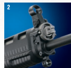
(1.) Folding stock, (2.) Two-position gas valve, (3.) Mini Red Dot sight
